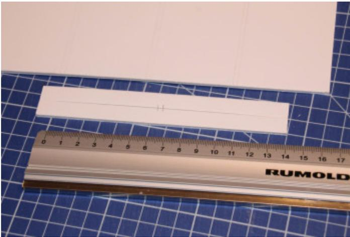
Seitenteile, Trennwände und Boden legt man nebeneinander vertikal an einer Leiste (bzw. den Zuschnitt-Winkel) aus, die markierten Seiten liegen dabei ganz außen. Die Trennwände (und ggf. auch die Seitenwände) sind ja in Materialstärke kürzer als der Boden, also sorgt man mit einem kleinen Materialabschnitt am Lineal für den richtigen Abstand
