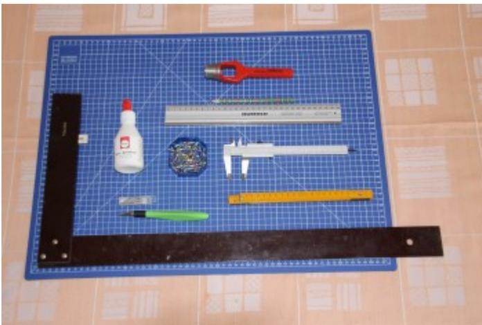
Das wichtigste Werkzeug ist zweifelsohne der **Cutter**, ein Messer mit scharfen Wechselklingen (hier mit grünem Griff), die mit einem einfachen Schraub-Klemm-Verschluss am Griff befestigt werden. Er sollte gut in der Hand liegen, ein leicht dreieckig geformter Griff ist z.B. praktisch, um auch nur leichte Drehungen beim
