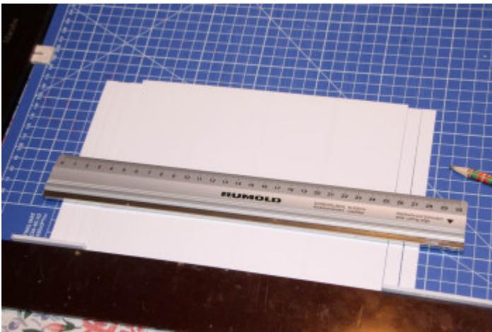
An den Kreuzpunkten der Trennwände schneidet man bis zur Hälfte ein und mit vorsichtigen Schnitten quer in der Mitte von beiden Seiten bricht man das Stück heraus. Mehrere Kerben werden stets von der gleichen Seite geschnitten! Die horizontal bzw. vertikal verlaufenden Trennwände haben nachher jeweils entweder alle Kerben oben (diese werden zuerst auf den Boden geleimt) oder unten.
