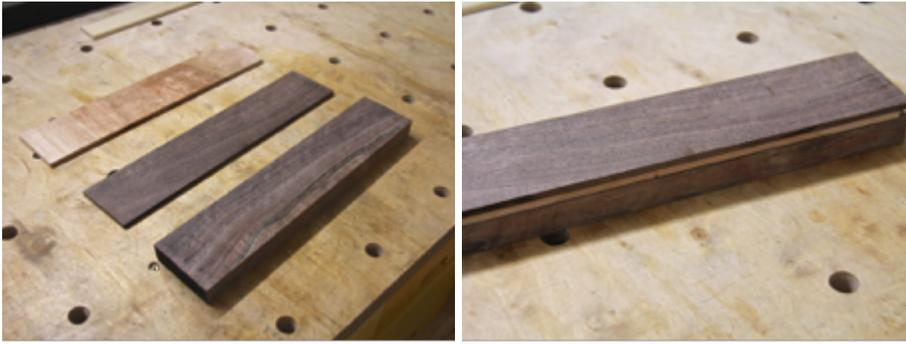
Auf jede Fläche, die mit einer Fläche eines anderen Brettchens verbunden werden soll, wird eine dünne und geschlossene Schicht Weißleim aufgetragen. Ich verwende gerne eine Anpressrolle für Tapeten, es kann aber
