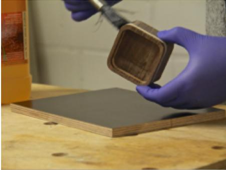
Nach dem Schleifen und Ölen und Polieren sehen die [Token](#)-Schalen dann so aus. Der Kork (hier mit 2 mm Überstand) ist ebenfalls mit Holzleim befestigt.
